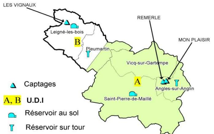
L'UDI **B** des *Vignaux* est alimentée par le forage des *Vignaux* situé sur la commune de *Leigné les Bois*. D'une profondeur de 55 mètres, il capte les eaux de la nappe aquifère semi-captive du turonien.
