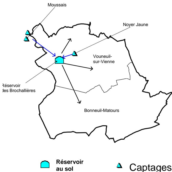
**Traitement :** l'eau provenant de Moussais fait l'objet d'une déferrisation suivie d'une désinfection au chlore gazeux. Elle alimente le réservoir des Brochallières.
